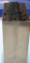
厚い鉄板も一回で深くまで溶接
