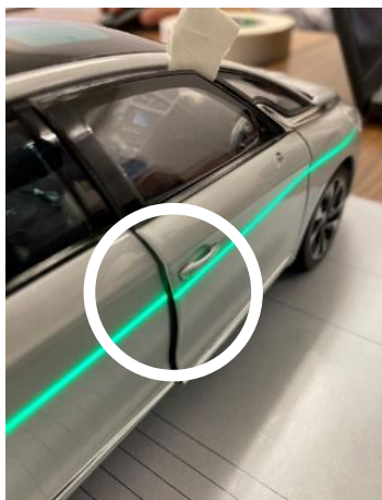
段差、隙間をカメラで監視
